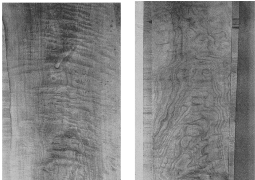
Abb. 6. Messerfurnier (links) und Schälffurnier (rechts) aus einem Aststück in 4–7 m Höhe eines Stammes im Ostseebad Koserow auf Usedom.
